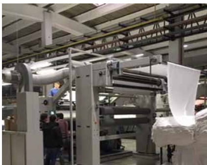
Segmentregelwalzenanlage SWA9511 am Einlauf Rotationsdruckmaschine
