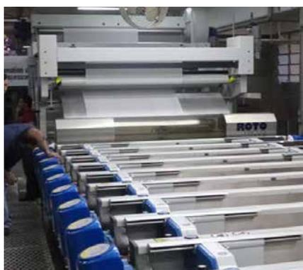
Alinhador de rolo segmentado SWS95 na entrada da máquina de impressão rotativa
