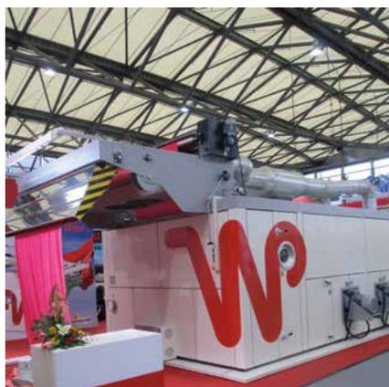
Sistema de alinhamento com rolos segmentados SWA9501 na saída da secadora
