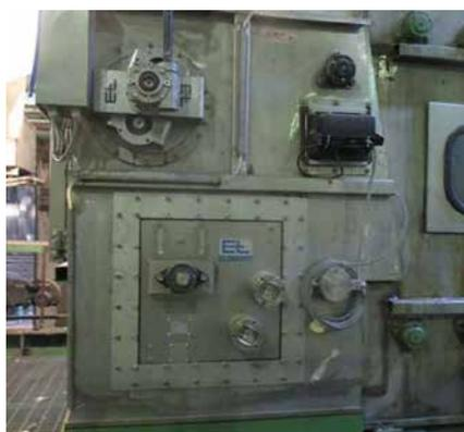
Alinhador de rolo segmentado SWS97 e LG05 no vaporizador de alvejamento
