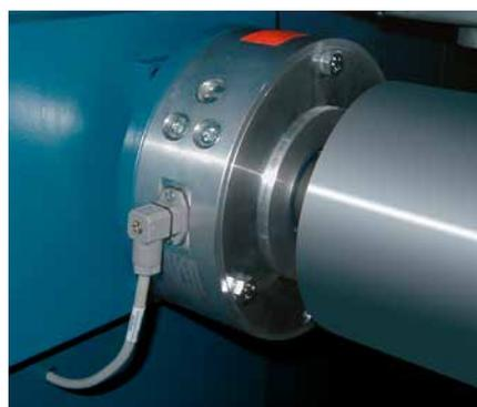
Célula de carga PD 25 na entrada to tanque de tingimento
