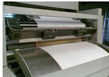
Alinhador do rolo segmentado SWS94 na entrada da máquina de impressão rotativa
