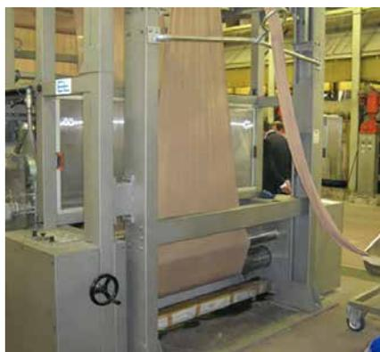
Alinhador de rolo segmentado SWS96 em máquina de abertura de malha tubular
