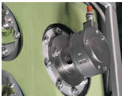
Célula de carga PD 23 na máquina de lavar
