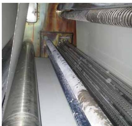
Alinhador de rolo segmentado SWS97 no vaporizador de alvejamento
