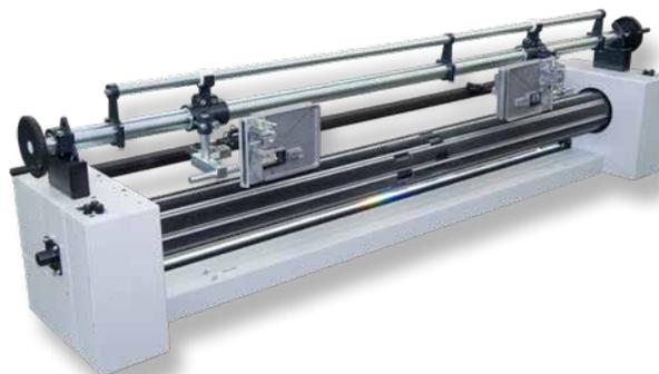
Alinhador de rolo segmentado SWS95 com abridor de orelas pneumático LP 03
